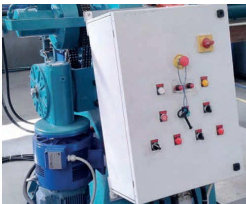
Quadro elettrico di comando e potenza inerente 2 avvolgitori in linea.
